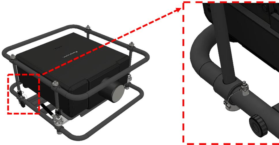
Abbildung 30 Sperrbolzen am Rahmen
