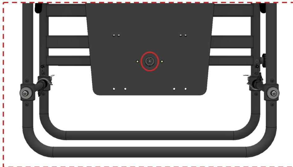
Abbildung 27 Mutter auf der mittleren Oberseite, die mit rotem Wachs versiegelt ist
