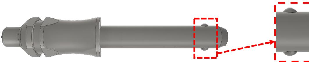
Abbildung 31 Sperrbolzen – die Kugelfeder
