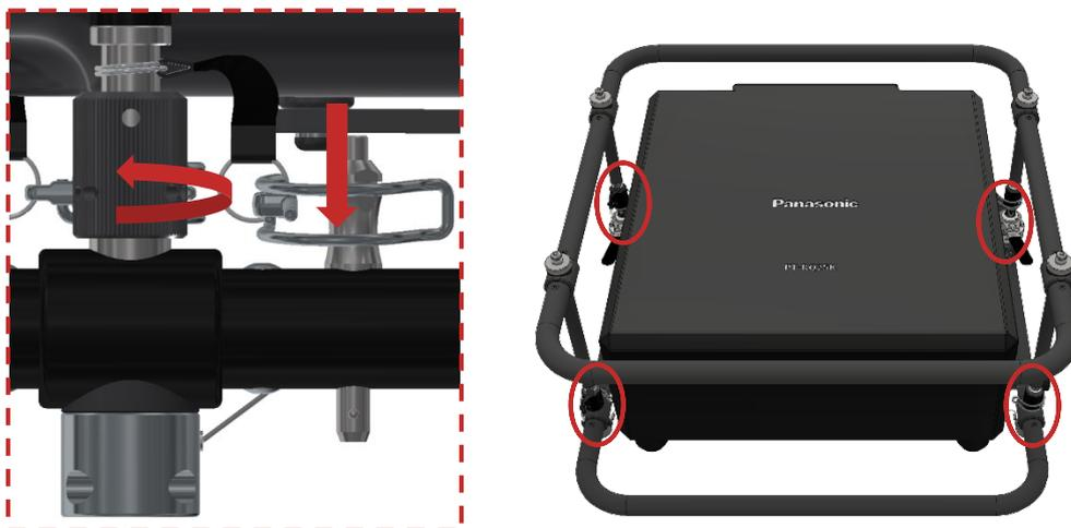
Abbildung 14 Festziehen der vier Befestigungsmuttern
