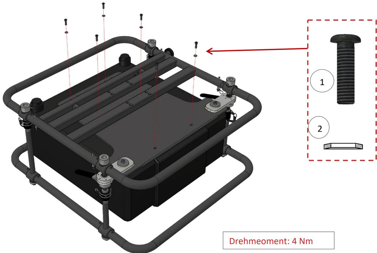
Vergewissern Sie sich, dass alle richtigen Schrauben und Sicherungsscheiben in der korrekten Position sind und sicher befestigt sind. Für weitere Details siehe Kapitel 7. Installation der Projektoren in den Rahmen.
