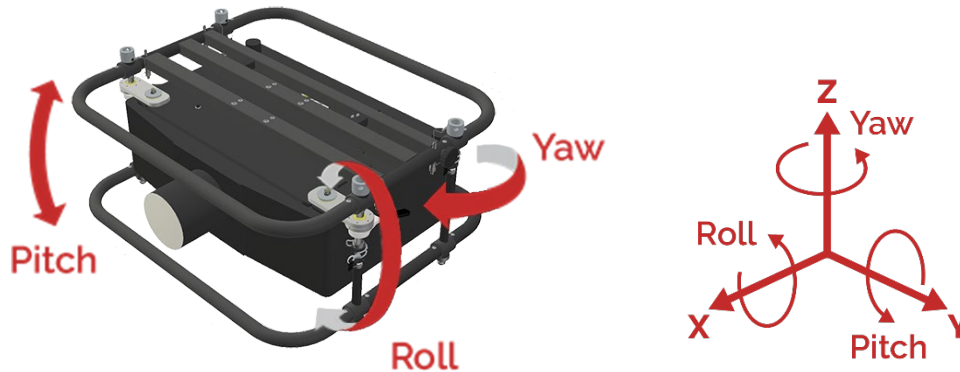
Abbildung 14 Darstellung von Yaw, Pitch und Roll
