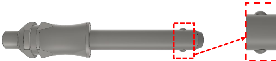
Abbildung 29 Sperrbolzen – die Kugelfeder
