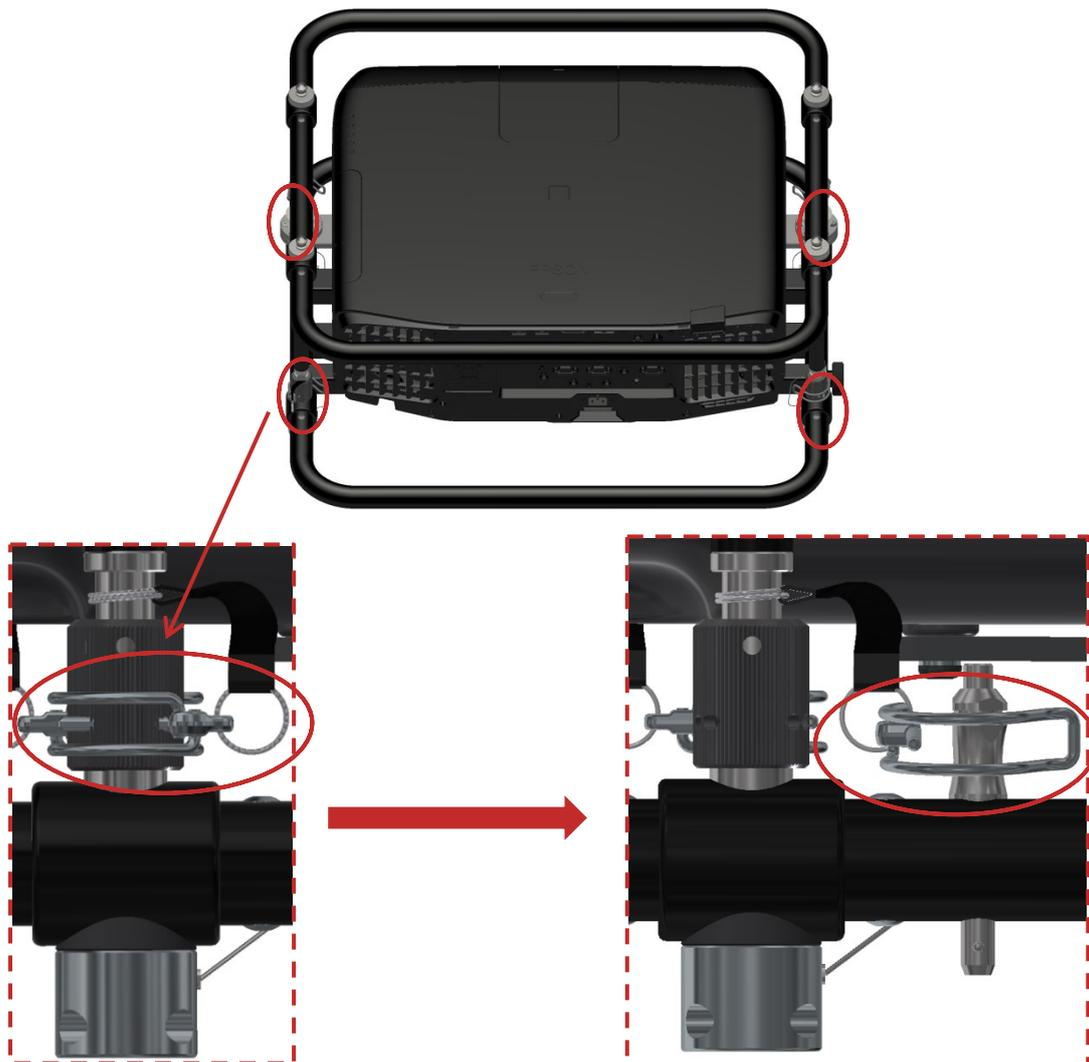
Abbildung 9 Entfernen der vier Federclips
