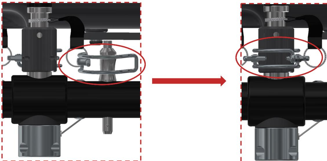
Abbildung 16 Erneutes Einsetzen und Sichern der vier Federclips
