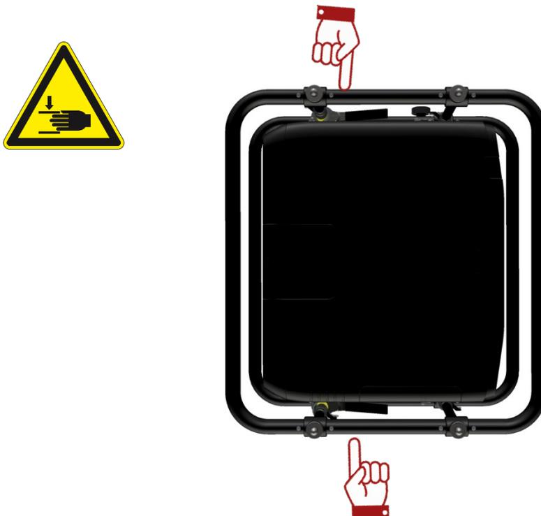
**Der Benutzer kann sich zwischen Federclips und den Befestigungsmuttern des oberen Teils des Rahmens die Finger einklemmen.**
