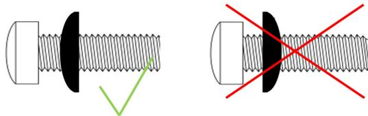
Abbildung 7 Ausrichtung der Schnorr-Sicherheitsunterlegscheiben
