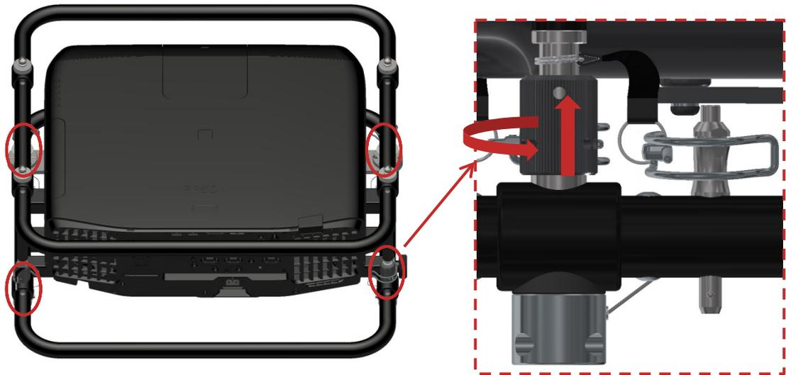
Abbildung 10 Lösen der vier Befestigungsmuttern
