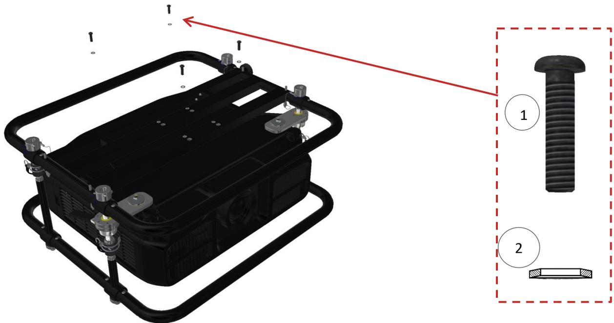
Stellen Sie sicher, dass sich alle richtigen Schrauben und Sicherheitsunterlegscheiben in der richtigen Position befinden und sicher befestigt sind. Weitere Details siehe Kapitel 7. Installation der Projektoren in den Rahmen.
