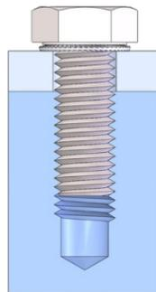
Abbildung 8 Korrekte Ausrichtung der Schnorr-Sicherheitsunterlegscheibe (Foto von Schnorr)
