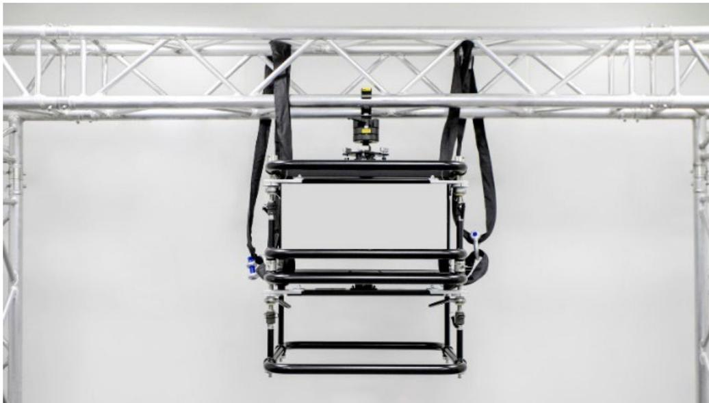
Abbildung 25 Sichern von zwei Frames mit zwei Sets Rundschnur
