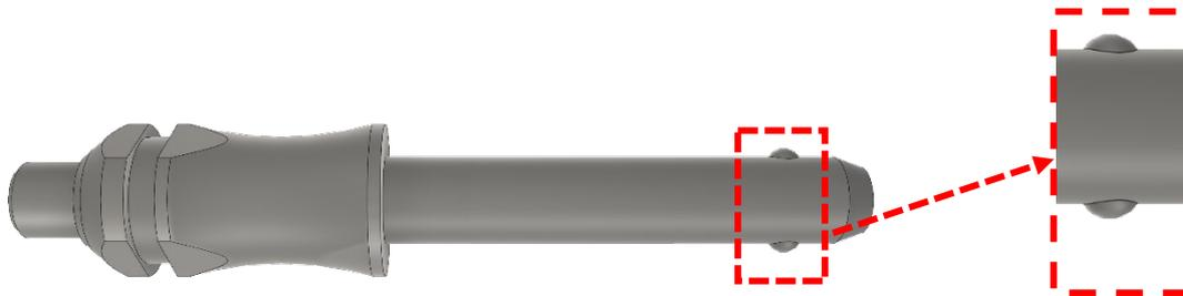
Abbildung 32 Sperrbolzen – die Kugelfeder
