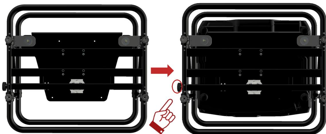
Abbildung 5 Montage des Projektors im Rahmen
