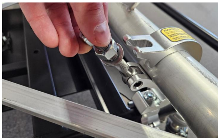
Abbildung 7 Befestigen großer Schellen an der tragenden Struktur (Traverse/Rohr)
