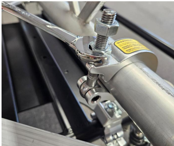
Abbildung 8 Anziehen der ersten Mutter an der großen Schelle
