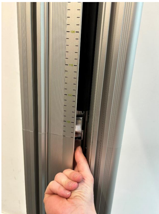
Abbildung 12 Lösen des Spannverschlusses
