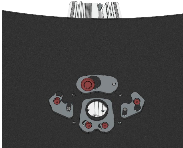
Abbildung 7 Drehen zum Verriegeln – Ansicht von unten
