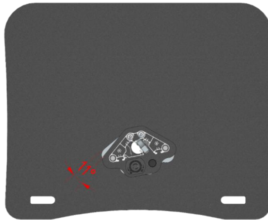
Abbildung 5 Richtige Positionierung der Säule im nicht verriegelten Zustand
