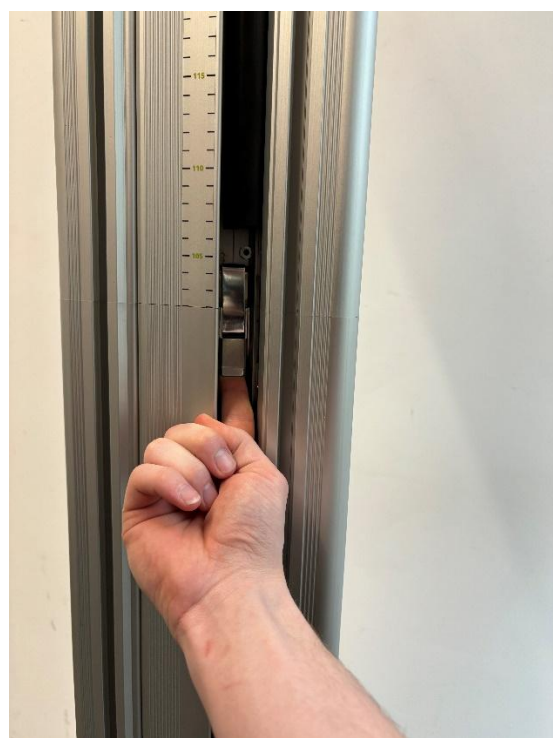
Abbildung 12 Lösen des Spannverschlusses
