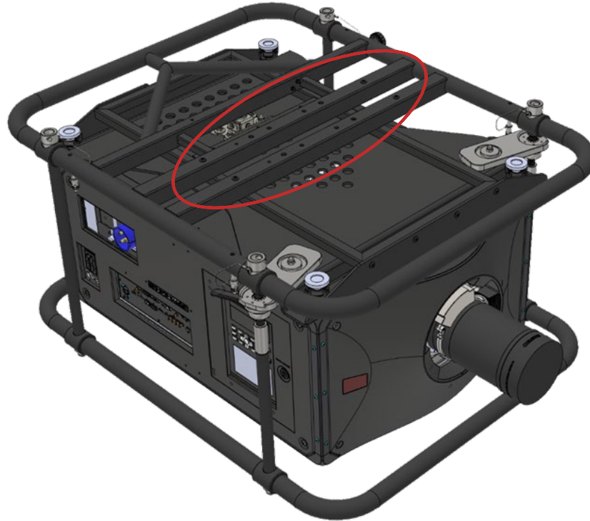
Abbildung 10 Gewindebohrungen an der Unterseite des Rahmens
