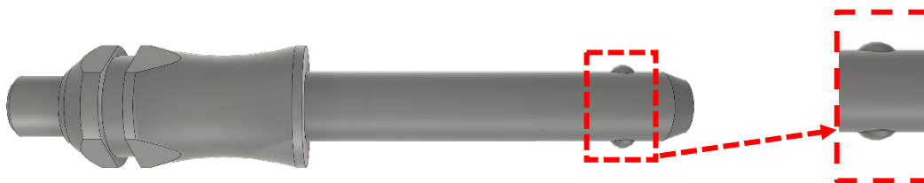
Abbildung 20 Sicherungsstift – die Kugelfeder
