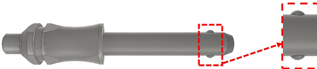
Abbildung 29 Sperrbolzen – die Kugelfeder
