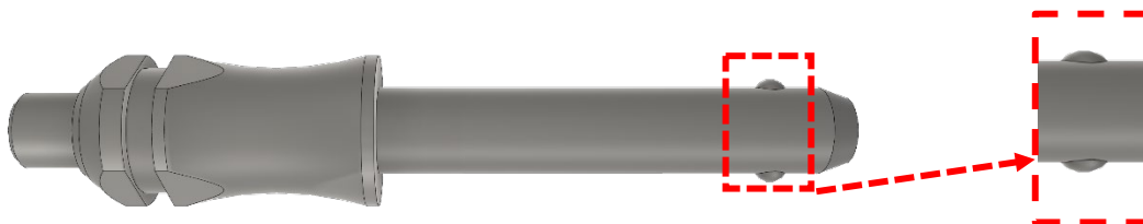
Abbildung 23 Sicherungsstift – die Kugelfeder
