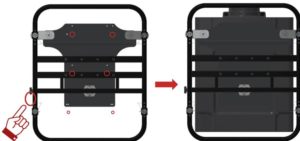
Abbildung 4 Montage des Projektors im Rahmen
