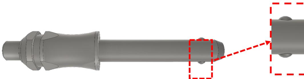
Abbildung 31 Sperrbolzen – die Kugelfeder
