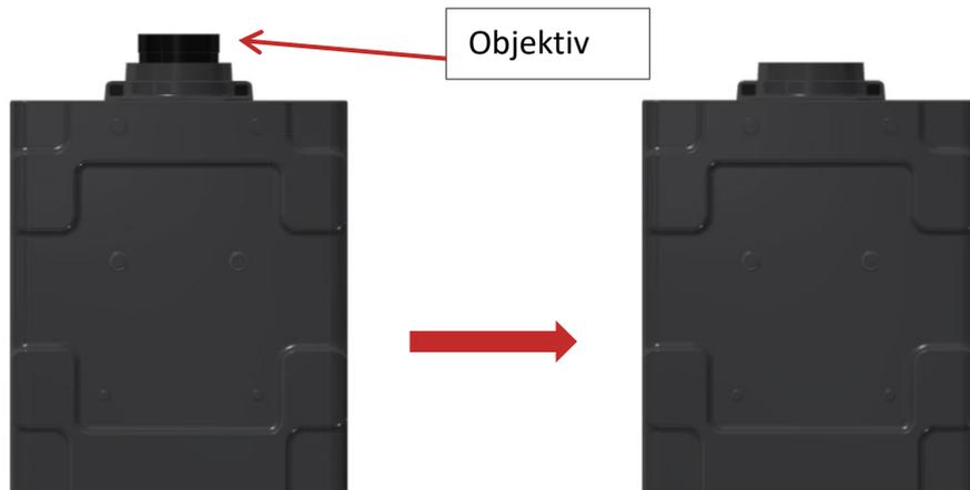
Abbildung 3 Entfernen des Objektivs
