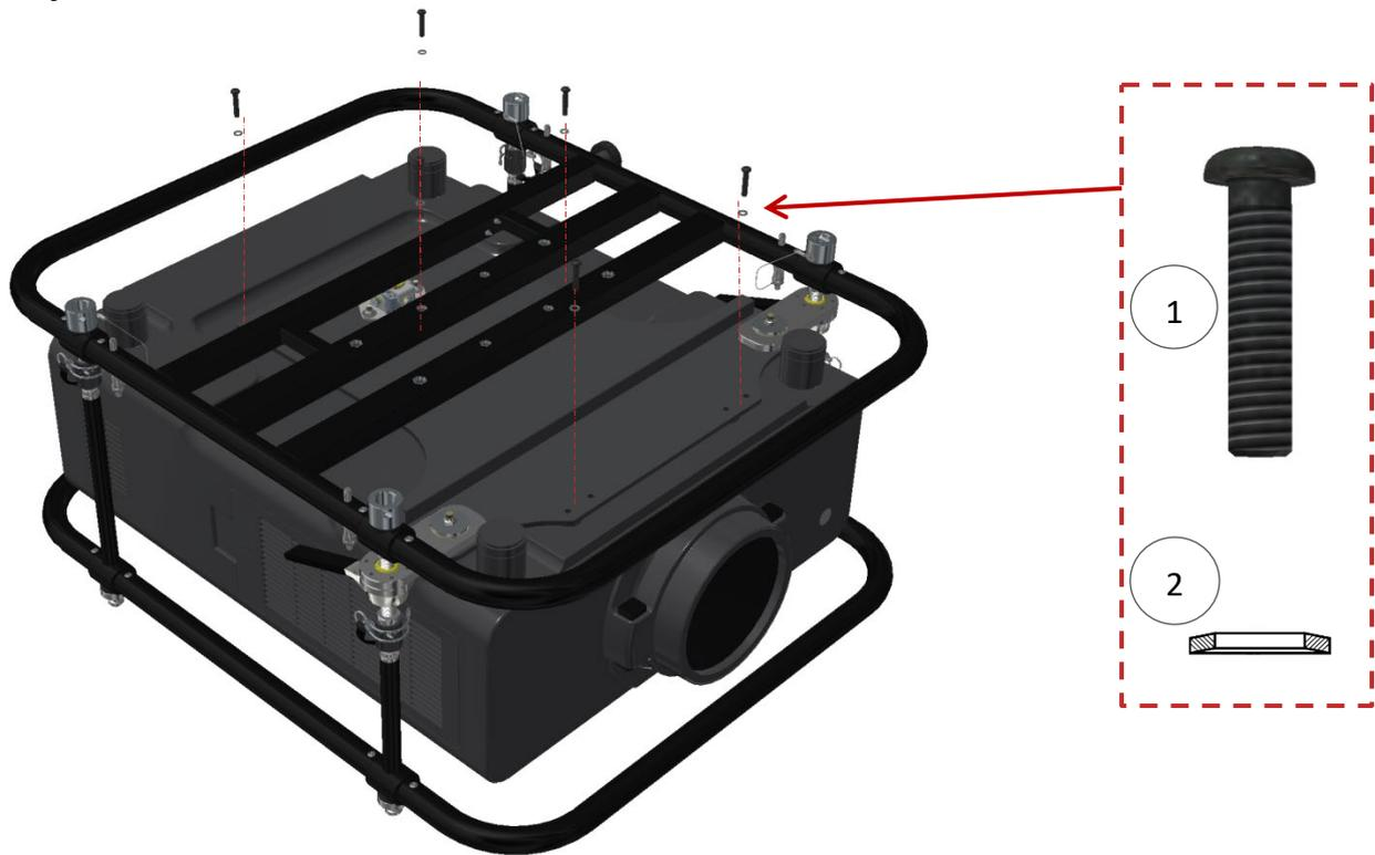
Stellen Sie sicher, dass sich alle richtigen Schrauben und Sicherheitsunterlegscheiben in der richtigen Position befinden und sicher befestigt sind. Weitere Details siehe Kapitel 7. Installation der Projektoren im Rahmen.
