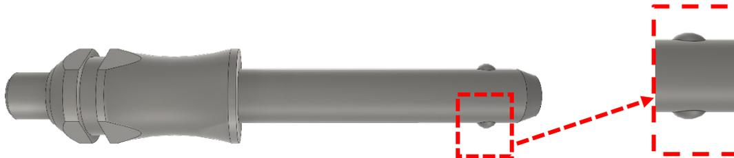
Abbildung 30 Sperrbolzen – die Kugelfeder
