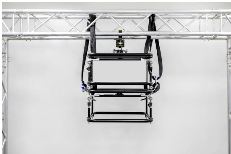
Abbildung 23 Sichern von zwei Rahmen mit zwei Sätzen Rundschlinge
