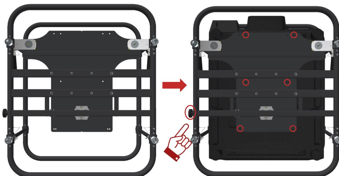
Abbildung 4 Montage des Projektors im Rahmen
