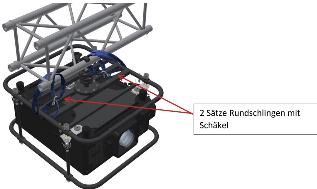
Abbildung 22 Sichern eines Rahmens mit zwei Sätzen Rundschlingen
