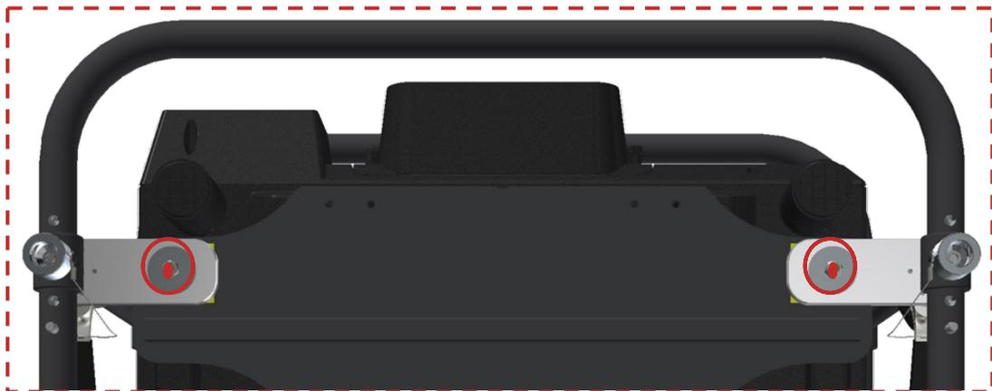
*Abbildung 25 Muttern auf der vorderen Unterseite, die mit rotem Wachs versiegelt sind*
