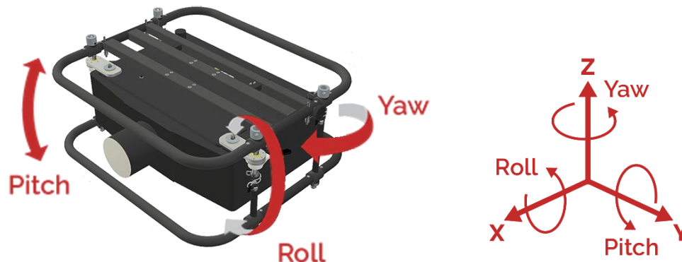
Abbildung 14 Darstellung von Drehen, Nicken und Rollen
