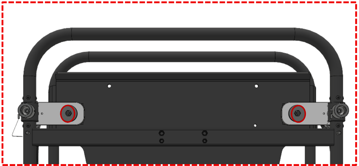
Abbildung 24 Muttern auf der Unterseite vorn, die mit rotem Wachs versiegelt sind
