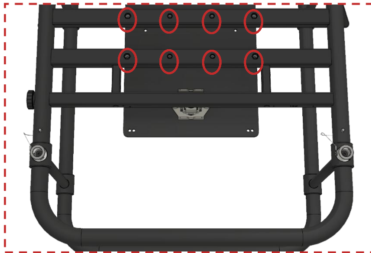
Abbildung 19 Kontrolle der Gewindebohrungen an der Unterseite
