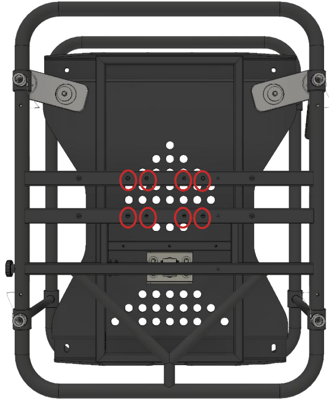
Abbildung 9 Unterseite eines besonders großen Rahmens EVO-C40H mit markierten Befestigungspunkten
