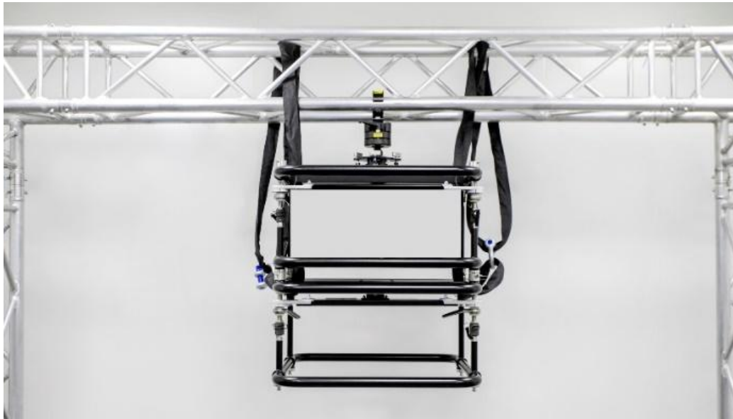
Abbildung 17 Sichern von zwei Rahmen mit zwei Sätzen Rundschnellen
