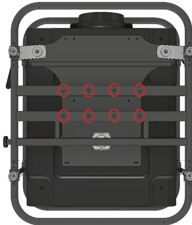
Abbildung 7 Unterseite eines größeren Rahmens (EVO-P20) mit markierten Befestigungspunkten
