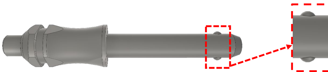
Abbildung 29 Sperrbolzen – die Kugelfeder
