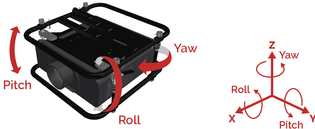
Abbildung 14 Darstellung von Yaw, Pitch und Roll
