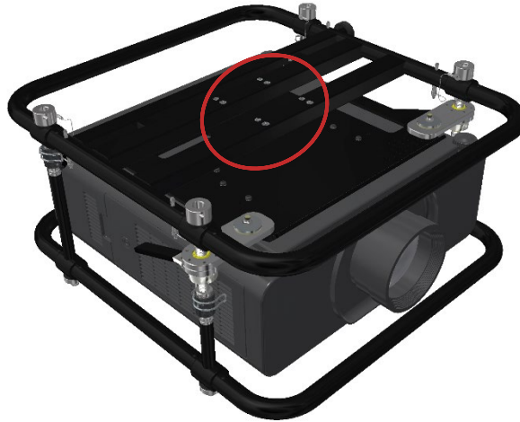
Abbildung 21 Gewinde an der Unterseite des Rahmens
