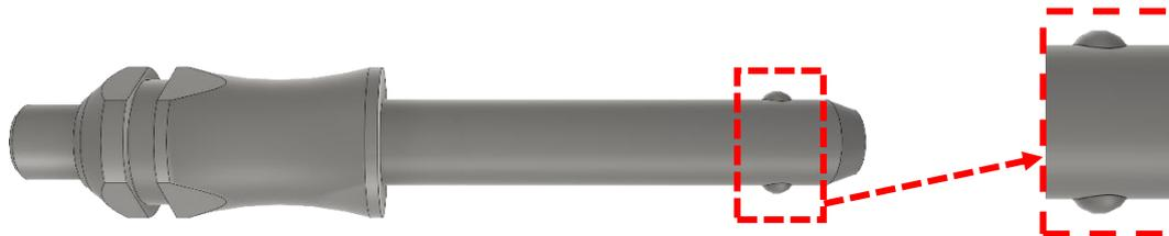
Abbildung 31 Sperrbolzen – die Kugelfeder
