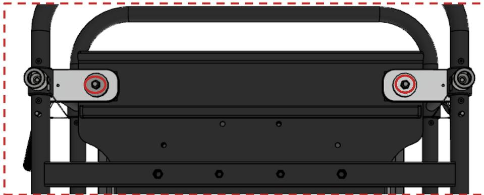
Abbildung 26 Muttern auf der vorderen Unterseite, die mit rotem Wachs versiegelt sind
